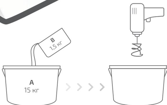
Двухкомпонентный безусадочный отверждающийся герметик «Сазиласт 22» подходит для герметизации стыков строительных конструкций и их ремонта.
