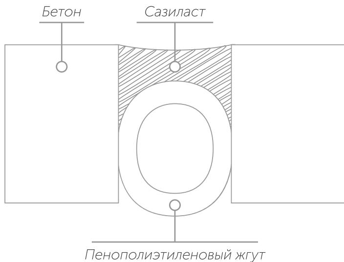
Жгут устанавливают насухо в горизонтальные и вертикальныестыки со стороны наружной поверхности стены в качестве подосновы под герметики.
